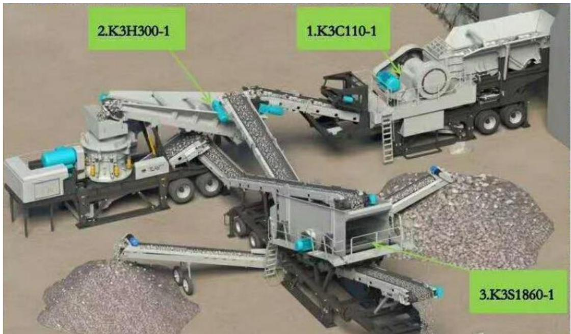
移动式处置站目前主要针对临时性的小规模建筑垃圾处置点，用于处理以混凝土块为主的建筑垃圾，不具有处理成分复杂建筑垃圾的能力；
