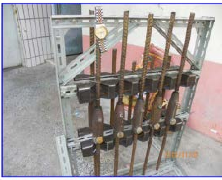
接头灌浆操作专用试验架
